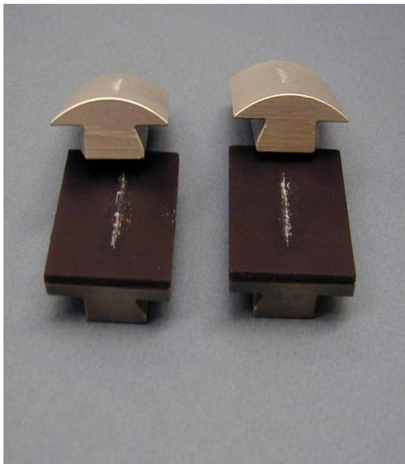
Abbildung 1: Konvex / plane Backenpaare – Kreidestrich zeigt Haltepunkt des Probenstreifens
