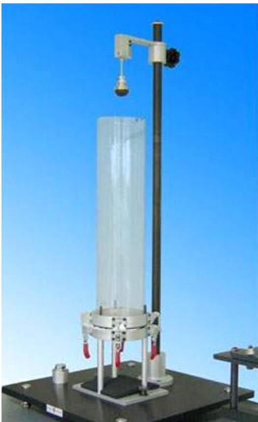
Abbildung 2 Dart-Drop Prüfeinrichtung
