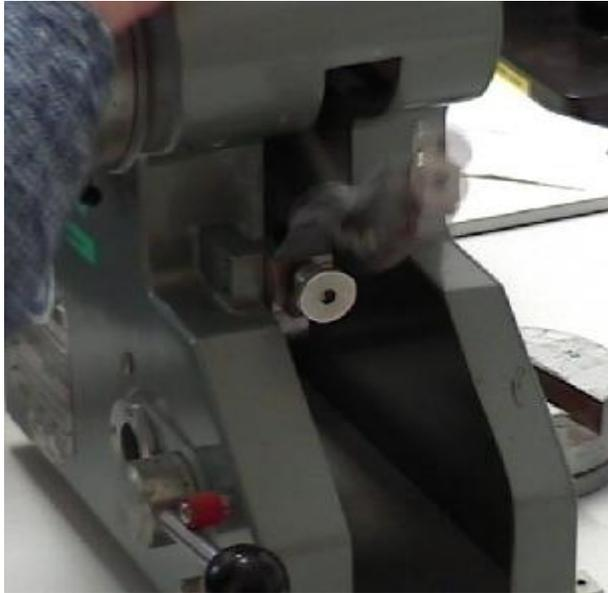
Abbildung 7 Foto während des Momentes der Prüfung des Dynamischen Weiterreißens
