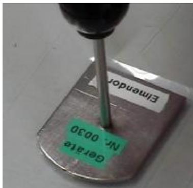
Die Prüfung selbst wird mit einem Pendelschlagwerk durchgeführt, welches die vorgestanzte, eingeschnittene Probe mit Fallgeschwindigkeit zerreißt. Es handelt sich somit nach unserer Definition in diesem Bericht um eine typische dynamische Prüfung, die das Ein- und Weiterreißen beim Handling von Folienverpackungen verschiedener Arten mit Messwerten vergleichbar macht.
