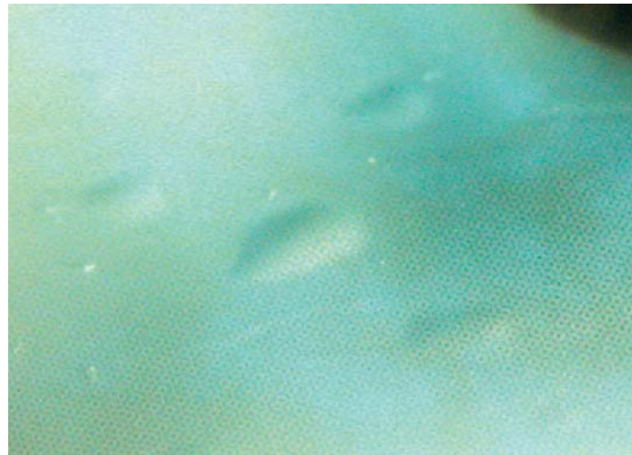
Abbildung 9 (links): Stippe in einer Folienschicht (Draufsicht und Schnitt)
